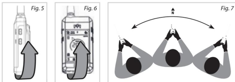
**AVERTISSEMENT:** La précision du cadran de navigation dépend du bon calibrage du compas numérique. En cas d'une indication imprécise de la direction du chien, procédez à un nouveau calibrage. Le fait de poser le récepteur à proximité du champ magnétique d'un autre objet ou dispositif peut entraîner une modification du calibrage du compas numérique – si cela arrive, il est nécessaire de procéder à un nouveau calibrage du compas.
